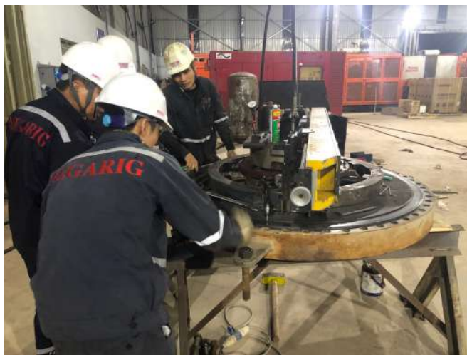
Gia công, tạo mặt phẳng bề mặt gương của mặt bích tại Nhà máy lọc hóa dầu Nghi sơn - Thanh Hóa/ Facing, Re-Facing & Flating at NSRP.
