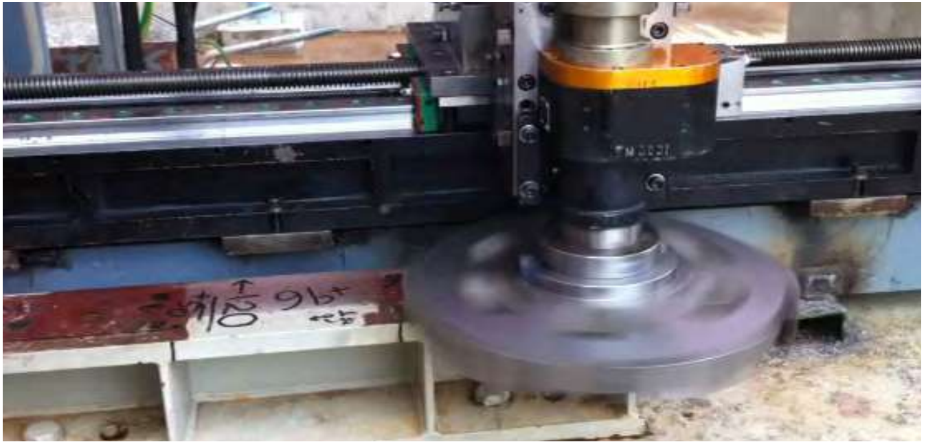
Gia công lại bề mặt để thiết bị tại nhà máy lọc hóa dầu Nghi Sơn/Motor base re-facing at NSRP.
