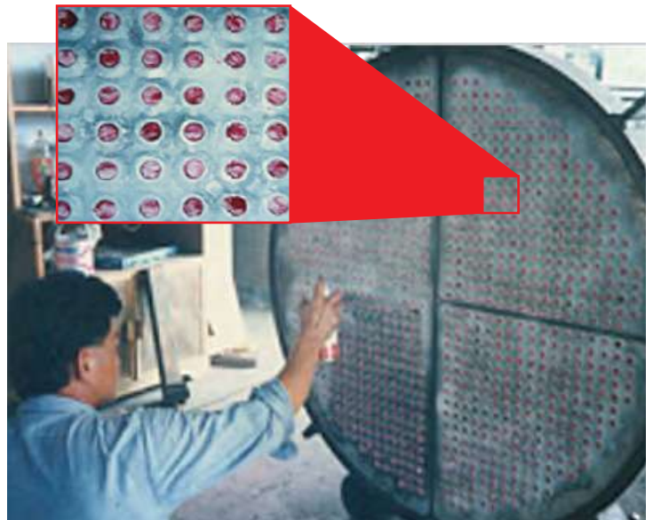
Kiểm tra mối hàn/NDT work for welding joint
