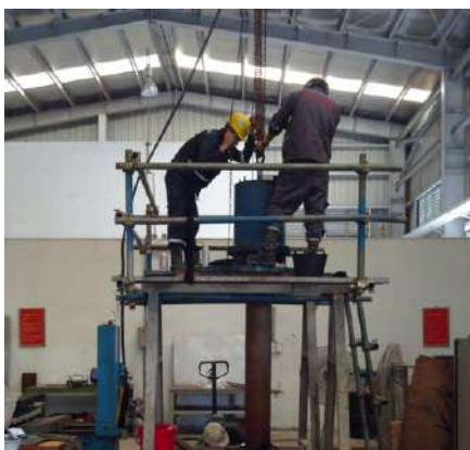
Sửa chữa bảo dưỡng, cân bằng động cánh bơm nhà máy ANP Thái Bình/ Repairing, maintain, and balance pump impellers of Thai Binh ANP factory
